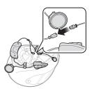
Затяните два винта универсальным гаечным ключом, до полной фиксации модуля к шлему.
