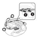
Вставьте динамик с более длинным проводом в правое посадочное углубление. Поместите провод микрофона ниже провода правого динамика. Вставьте динамик с более коротким проводом в левое посадочное углубление.
