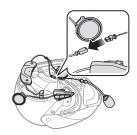
Затяните два винта универсальным гаечным ключом, до полной фиксации модуля к шлему.
