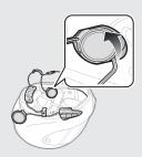
Вставьте заднюю панель модуля управления между корпусом и EPS наполнителем на левой стороне шлема.
