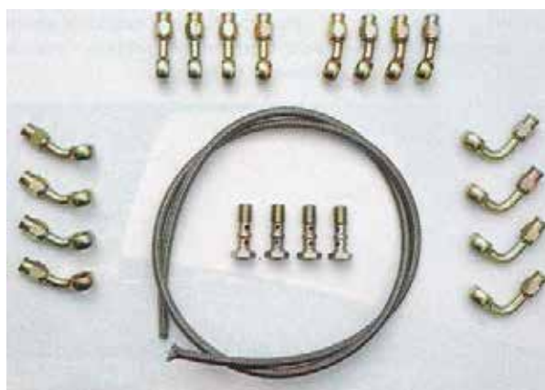
Армированная трубка, болты, штуцеры, изогнутые под разными углами: 20°; 45°; 90° или прямые.
